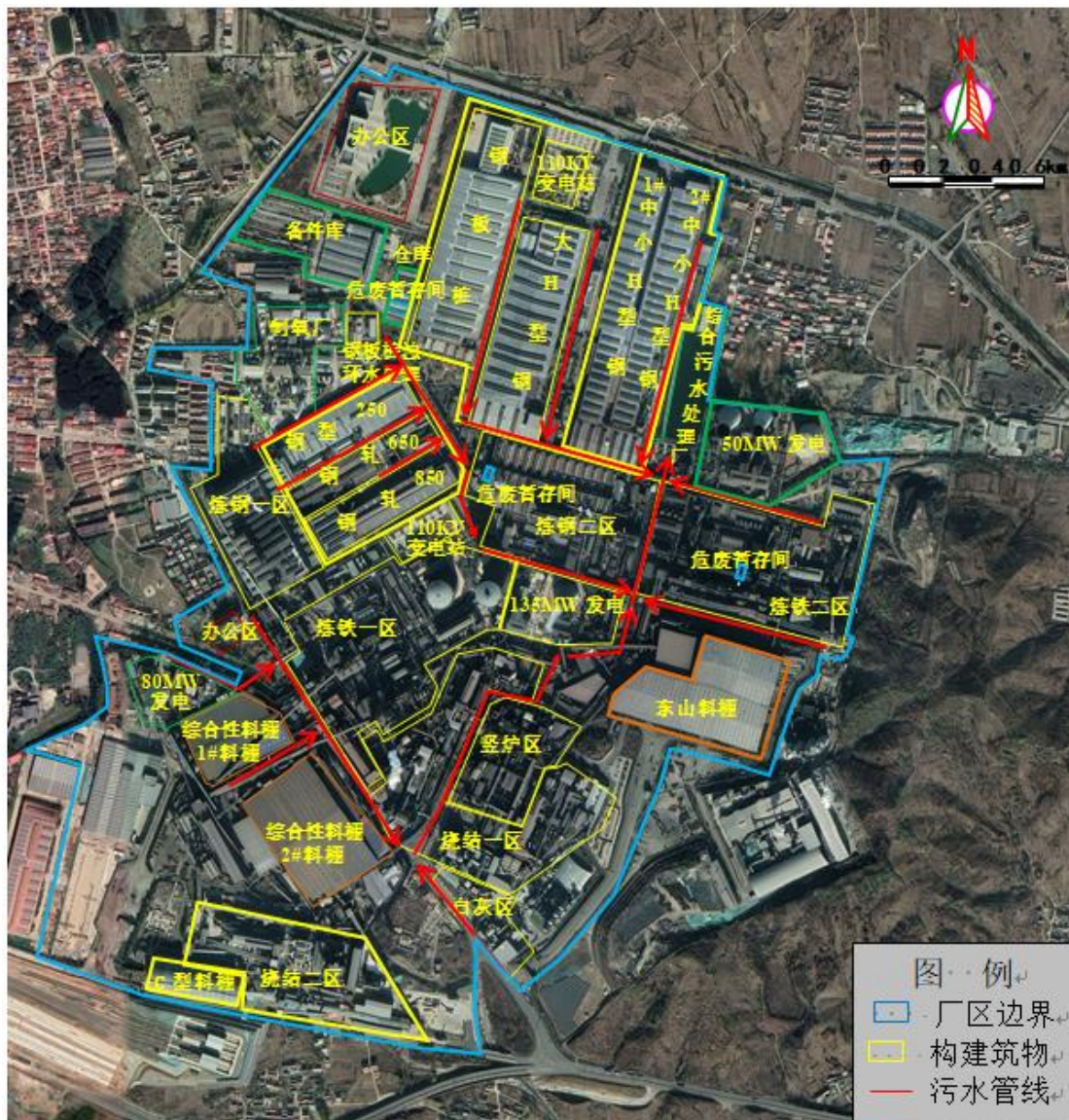
图 4.3-1 津西钢铁西区污水管线示意图
